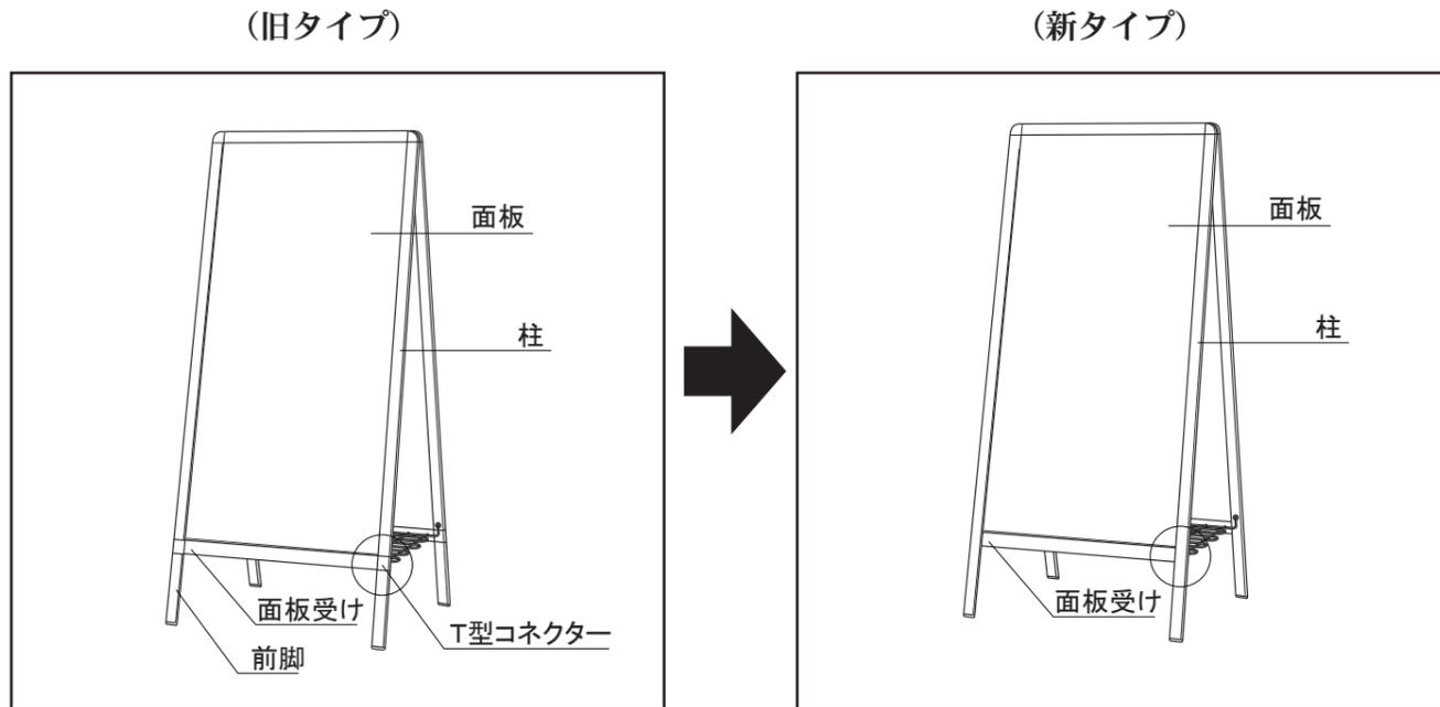
T型コネクターを無くし、柱フレームと面板受けを直接連結させる構造に変更させていただきます。
