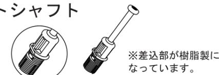
ジョイントシャフトを指定の板面穴に差し込みます。隙間が無いように最後まで差し込んでください。
