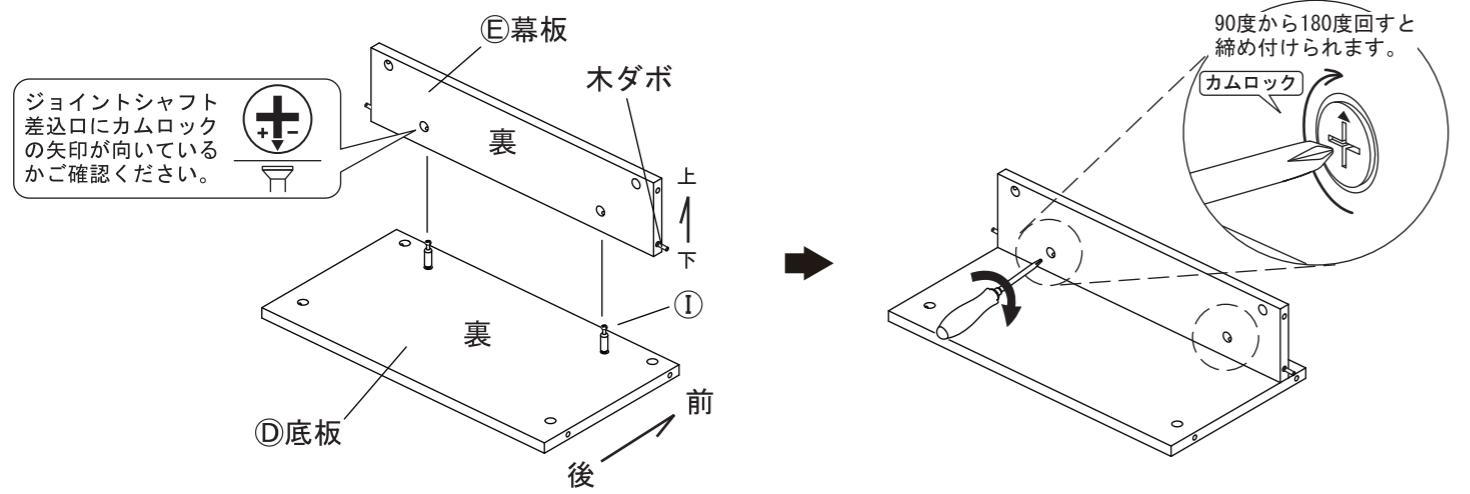
3 ②右側板の④41 ジョイントシャフトを⑥で組み付けた④底板・⑤幕板の横穴に差し込んでください。
