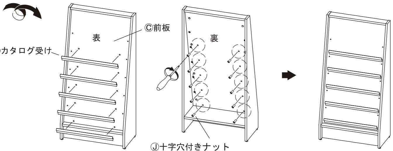
8 ⑤前板に⑥バーを組み付けます。プラスドライバーを使用し、⑧十字穴付きJねじを締め付けてください。
