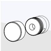
③キャップネジを締め付けてパネルを固定します。
