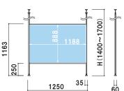
フレーム アルミ押出材アルマイト仕上 アジャスター ■ ABS 樹脂 + スチール 面板 ■ アクリル透明 3mm W1500 × H900 mm ※固定用ネジ付き
